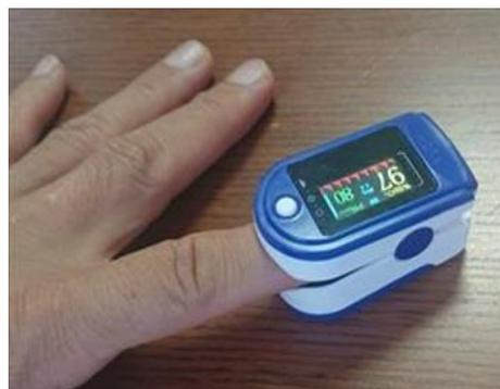
皮膚の上から光をあてて、動脈血の「赤み」を測定する原理の測定器で、測定値は経皮的動脈血酸素飽和度 (SpO<sub>2</sub>: Oxygen (酸素) の Saturation (飽和度) を Percutaneous (経皮的) に測定するの意味) として数字で表わされます。
