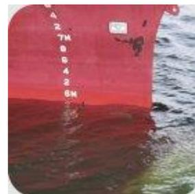
荷役設備に設けられた計量器の有無にかかわらず、大量のバラ積貨物の重量を迅速・的確かつ経済的に算出できる方法としてこの喫水検査が広く採用されています。
